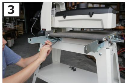
**3** 次に C. アウトフィードブラケット (短) 2本をドラムサンダー後部に取り付けます。取り付け方はインフィード側と同じです。
