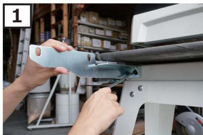
**1** 取り付け方向に注意して、B. インフィードブラケット (長) をドラムサンダー前側、コンベアーベルト下のボルト穴に取り付けます。D. ワッシャーと E. ボルト (M8 × 16mm) で固定してください。
