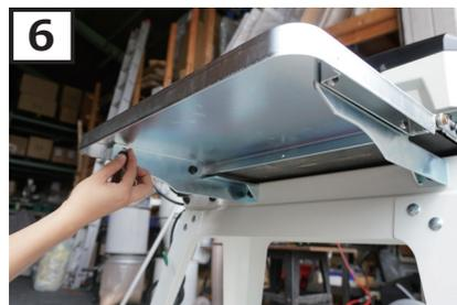
**6** テーブルの下側から D. ワッシャーと F. ボルト (M8 × 12mm) で固定しますが、ここでは指で軽く締めるだけにしてください。
