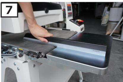
**7** 延長テーブルはコンベアーベルトより少しだけ下の位置に固定することが適切です。本体のドラムを上げてから、基準面が出ている直定規などをコンベアーベルトの片端に置きます。コンベアーベルトと延長テーブル両方に重なるように置いてください。
