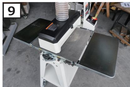
**9** 組み立ては終了です。実際に加工を行って確認してください。もし、研磨した材料が曲がったり、削りムラが発生するときはテーブルが高すぎる恐れがあります。手順④からの調整を行って、適切な位置になるよう調節してください。
