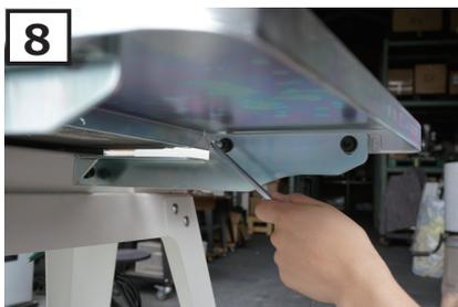
**8** 定規をコンベアーベルトにしっかり当て、延長テーブルの高さがほんの少し低い位置になるように調整します。位置が決まったら F. ボルト (M8 × 12mm) を締めてしっかりと固定します。固定し終わったら反対側も同様に調整します。一枚目のテーブルが終わったらもう一枚も固定してください。
